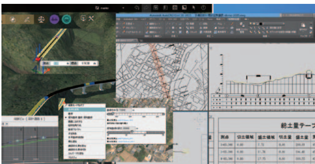
図3 オブリークカメラやレーザースキャナー、UAV画像等により取得された3次元データを周辺地形に重ね合わせたイメージ
