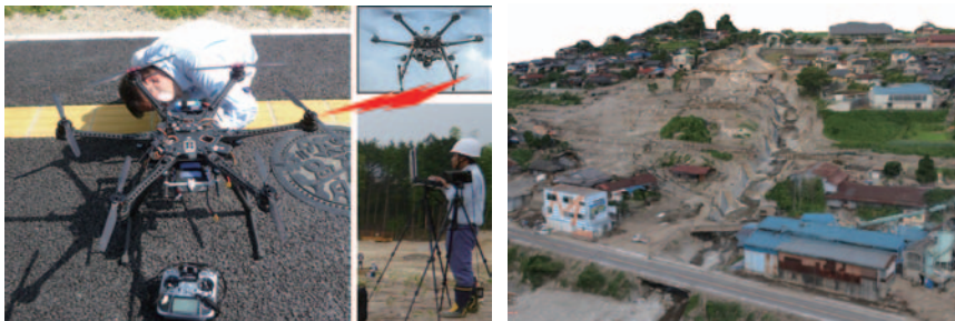
図2 左：UAV計測機材と計測風景、右：UAV画像から作成した地形モデル
