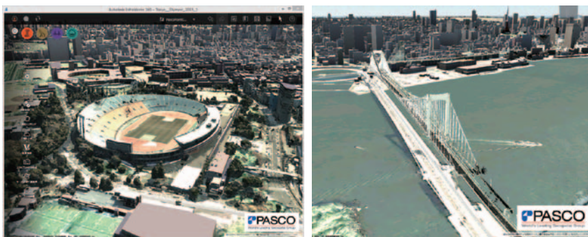
図3 オブリークカメラやレーザースキャナー、UAV画像等により取得された3次元データを周辺地形に重ね合わせたイメージ
