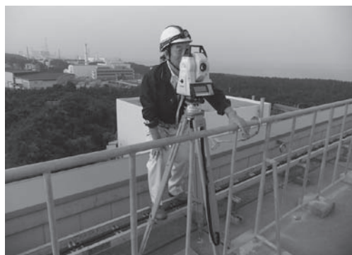
写真1 J-PARCの測量&アライメント
