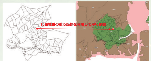
図-5 任意座標XMLから作成した登記簿地番図の仮配置手法の検討
