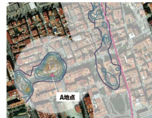
SAR衛星から解析した沈下量
