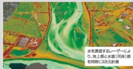
水を透過するレーザーにより、地上部と水底（河床）部を同時に3次元計測
