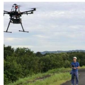
法令に基づく、撮影計画の策定から、精度を担保するための基準点設置に加え、飛行・撮影・計測、データの加工・処理までを一貫して行います。
