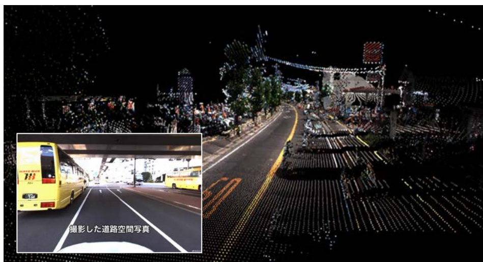
【道路空間の把握や電柱・電線、外看板の情報も取得】
