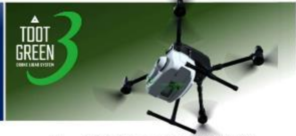
ドローンから水底の3次元地形を計測
