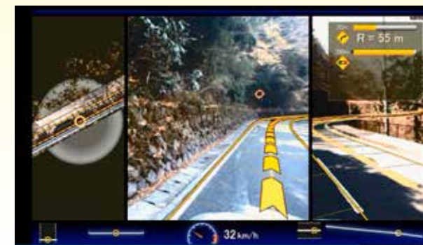
画面下: 車速、道路勾配、車両の傾きを示す 画面右上: カーブ曲率、高さ制限、信号などの先読み情報を示す 画面中央: 走行レーンや道路中心線を示す
