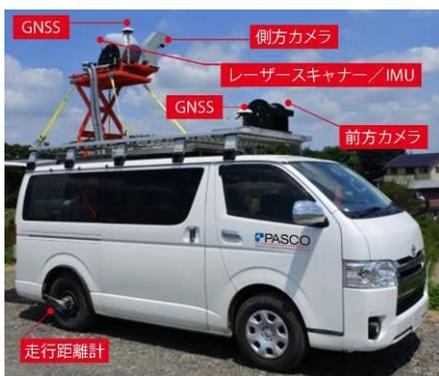
図1 MMS計測車両の概観
