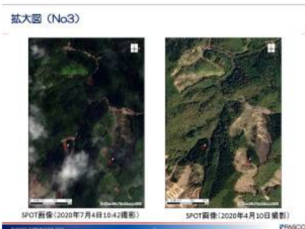
土砂移動判読（熊本県芦北町）
