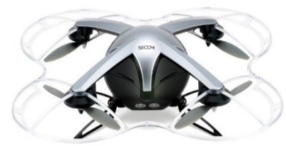
自律飛行型監視ロボット 「セコムドローン」
