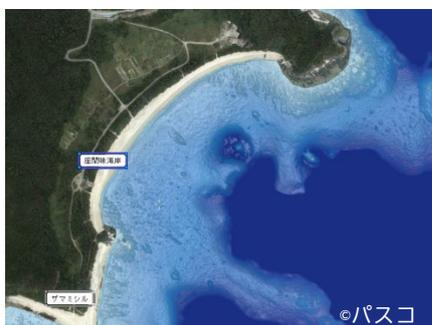
パスコが計測し作成した3次元海底地形データ
