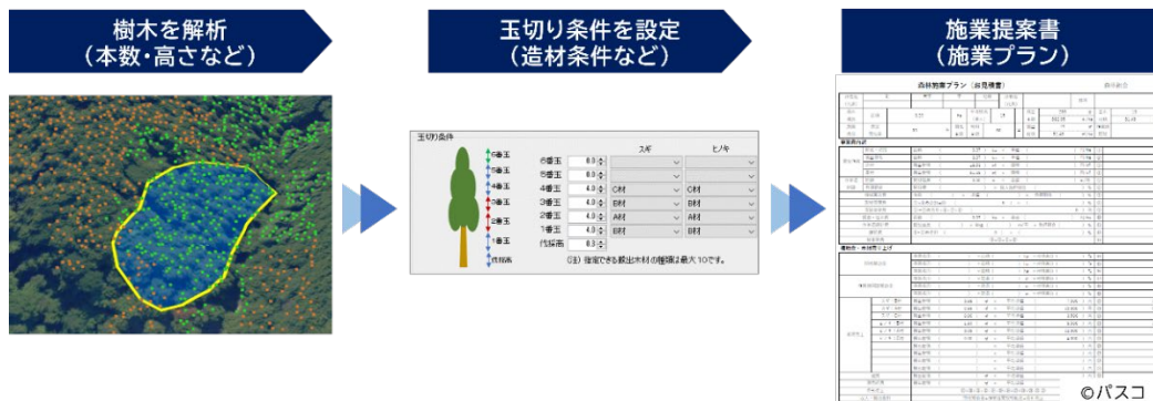
指定した範囲の単木データを集計、施業提案書を帳票形式で出力
