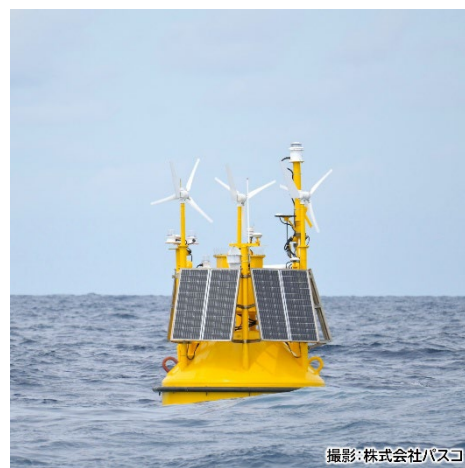
輪島沖に設置したフローティングライダー
