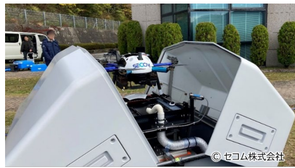
ダムの巡視・点検に使用した「セコムドローン XX」
